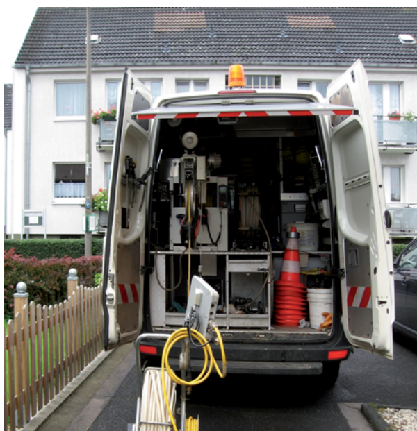
TV-Inspektionsfahrzeug im Einsatz
