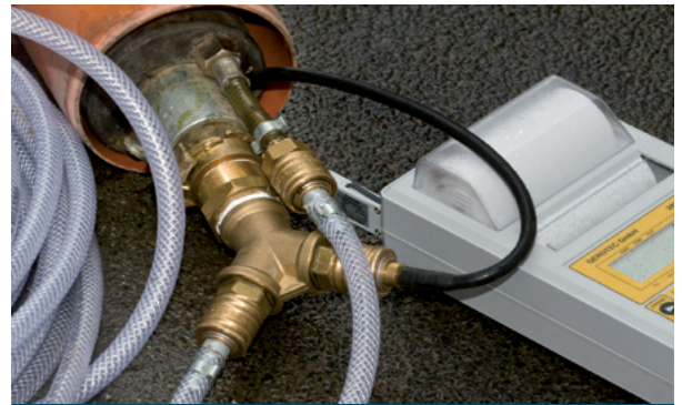
Gerät zur Dichtheitsprüfung mit Luftdruck
